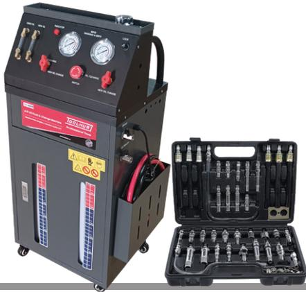
Diseñada para realizar el cambio, lavado y extracción de aceite para las transmisiones automáticas, en una amplia gama de marcas.
