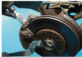
Diseñada para rectificar el labio del disco de freno tanto interior como exterior y poder reutilizar el disco sin tener la necesidad de reemplazarlo por uno nuevo. Se ajusta la manivela a través de un tornillo de la rueda y utilizaremos la cuchilla para rectificar el disco. Facil y rapido de utilizar para dejar nuestros discos nuevos.
