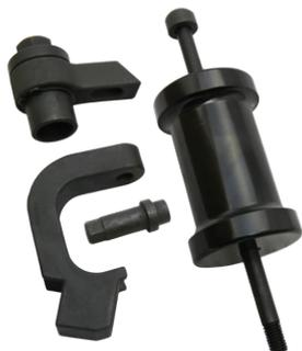
Herramienta para extraer inyectores Common Rail para motores 1.6 y 2.0 Tdi . Se sujeta el inyector por la parte de la entrada de combustible a través de dos tipos de adaptadores dependiendo el inyector y se fijan con un perno especial. Suministrado también el martillo de golpeo para poder extraer el inyector.
