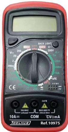
**Pantalla:** LCD de 3 1/2 dígitos (conteo de 1999) de 0,6" de altura
