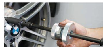
Esta herramienta especial que ahorra tiempo es adecuada para quitar las tuercas de bloqueo de BMW y Mini que tienen un anillo exterior giratorio. Utiliza un adaptador extractor para quitar la parte delantera del perno de la rueda y luego se usa una broca estriada especial que encaja dentro del perfil interior para desenroscar el perno sin dañar la llanta de la rueda.
